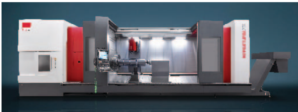
Con 84 kW al mandrino di tornitura e 80 kW su quello di fresatura, Hyperturn 200 Powermill può effettuare anche lavorazioni gravose su materiali tenaci
