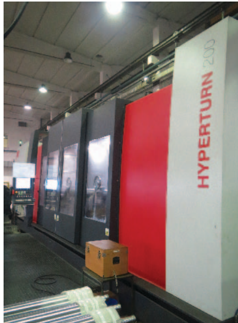
A sinistra: il centro di tornitura Hyperturn 200 Powermill installato in Zenit Spa
